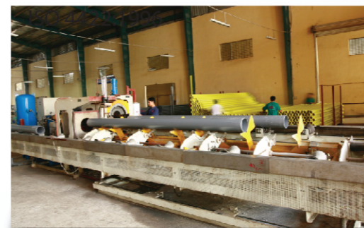
Bộ phận nong ống Pipe socketting department
